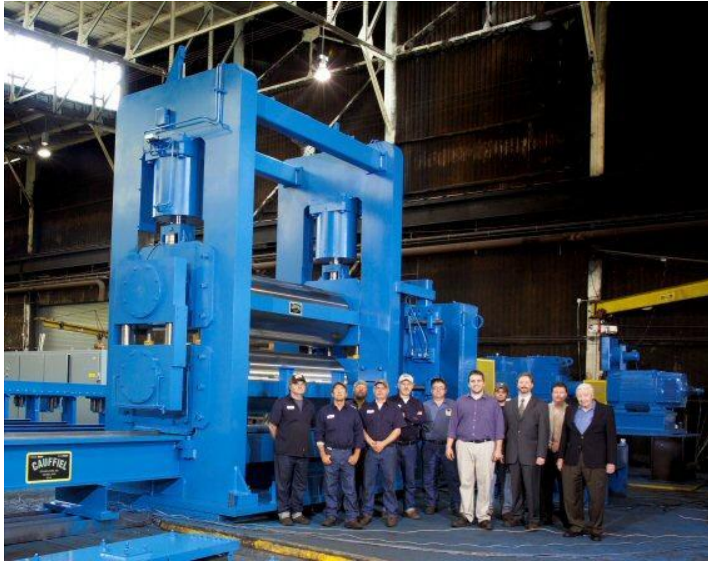
Fig. 7.4 (b) Laminador dúo de grandes dimensiones con ajuste hidráulico (Cauffiel Technologies).
