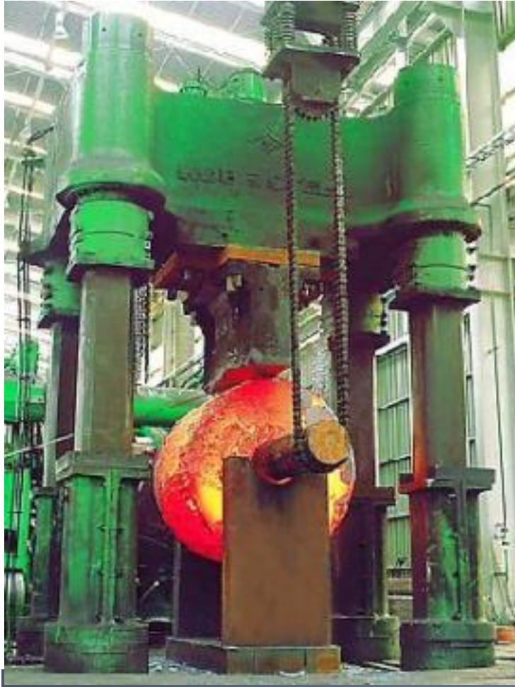
Fig. 6.16 (a) Prensa para forja abierta con capacidad de 4000 ton. Figura (b) Prensa hidráulica para forja en estampa con capacidad de 2000 ton.
