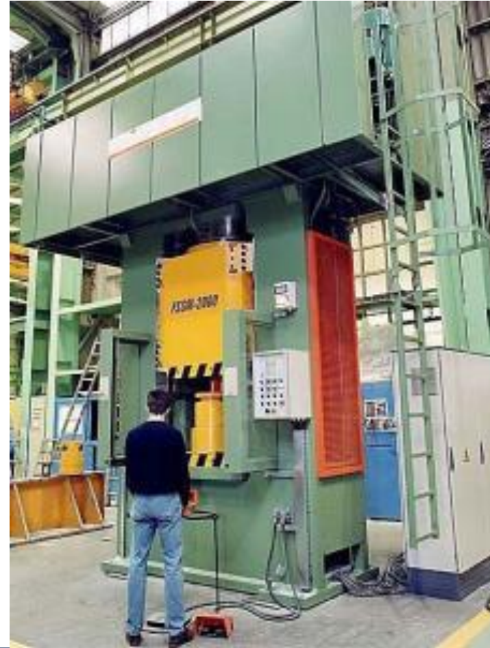
Fig. 6.16 (a) Prensa para forja abierta con capacidad de 4000 ton. Figura (b) Prensa hidráulica para forja en estampa con capacidad de 2000 ton.
