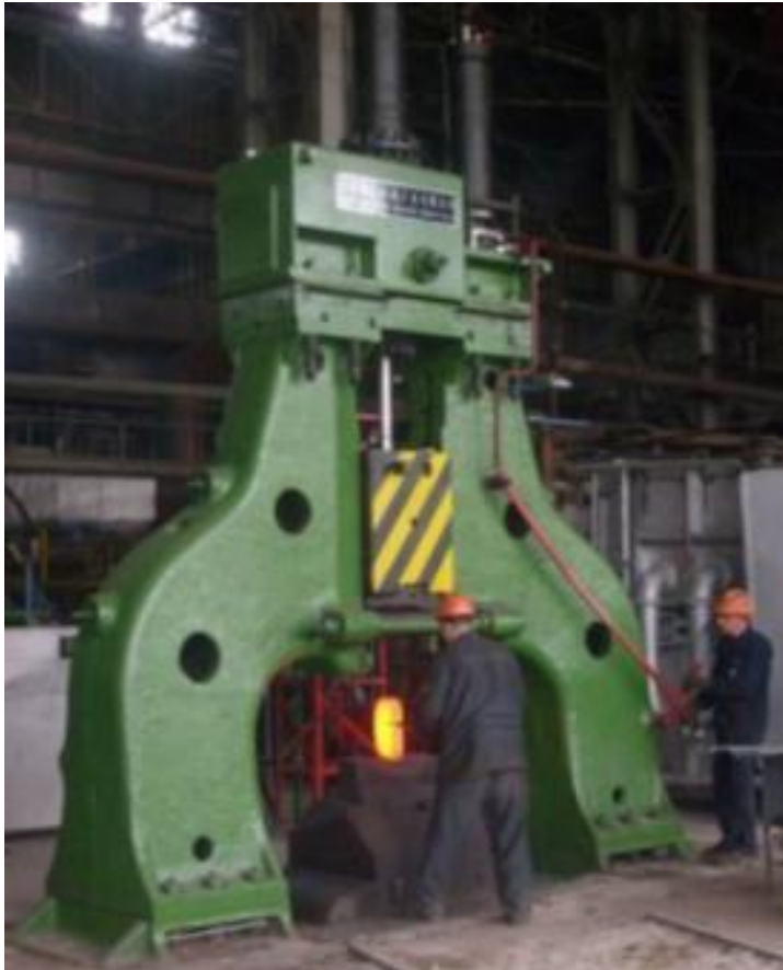
Fig. 6.3 (a) Forja en caliente en un martillo de bastidor abierto. (b) Forja en prensa. En ambos casos se trata de forja abierta
