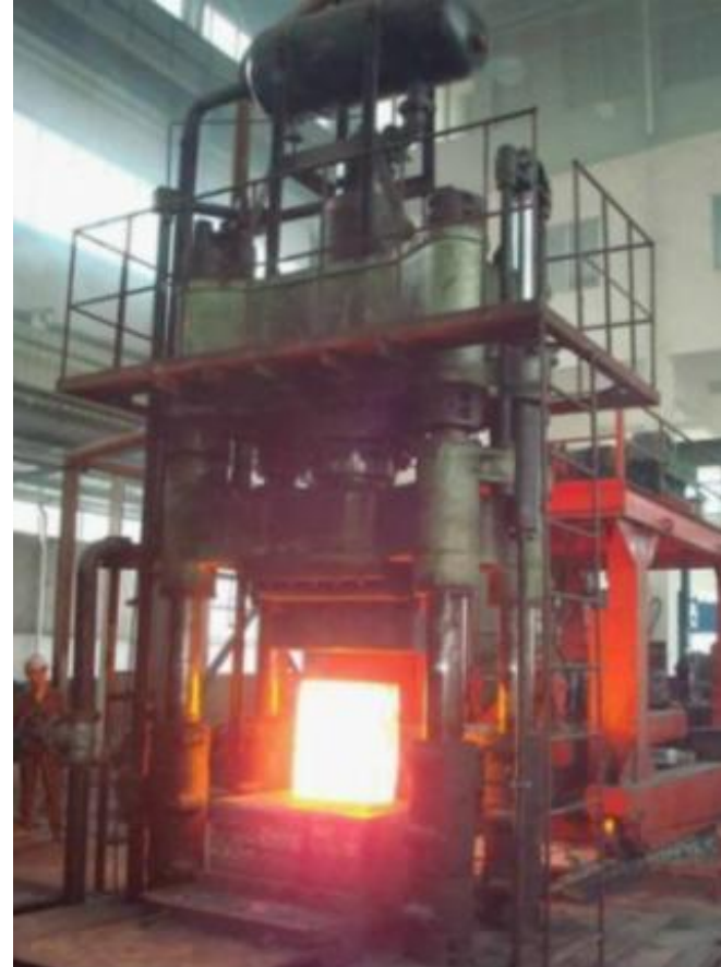
Fig. 6.3 (a) Forja en caliente en un martillo de bastidor abierto. (b) Forja en prensa. En ambos casos se trata de forja abierta
