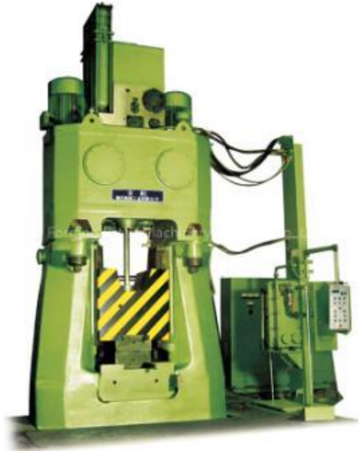
Fig. 6.15 (a) Martillo de bastidor cerrado para forja en estampa. Figura (b) Martillo de accionamiento neumático, 75 kg de la masa deslizante, 1 KJ de energía, hasta 210 golpes/minuto.
