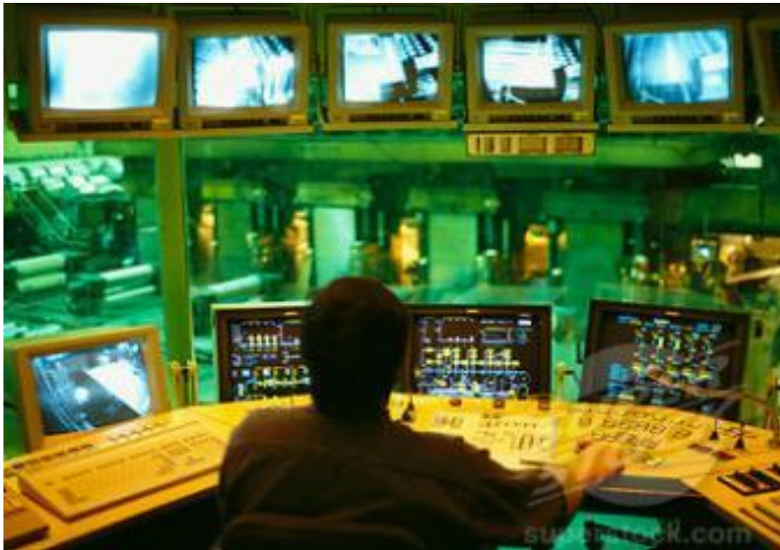
Fig. 7.15 El control del proceso de laminación se efectúa a través de complejos sistemas computacionales y de adquisición de datos.
