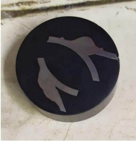
El profesor nos proporcionó una segunda pieza que ya estaba en su montadura, para la cual únicamente se realizó pulido y ataque químico. Ésta se muestra en la Figura 6. También correspondía a un tubo calibre 40 con un diámetro nominal de una pulgada.
