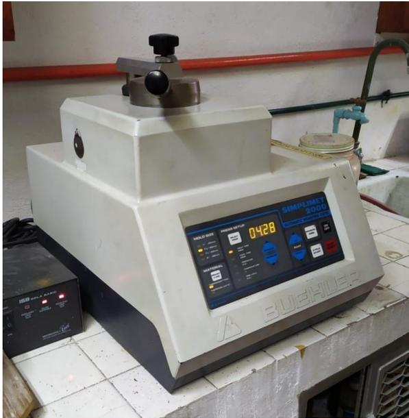
Figura 4. Montadora automática
