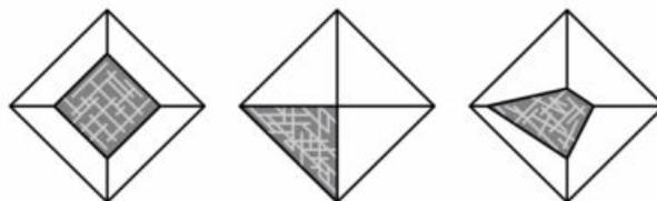
Diagrama 1: Corte perpendicular al eje del octaedro, paralelo a una de las caras, y corte con un ángulo distinto.
