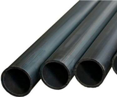
En este trabajo trabajamos con un tubo cédula 40, con medidas: diámetro exterior 1.315 pulgadas, diámetro interior 1.049 pulgadas y con un espesor 0.113 pulgada. La cual tenía una falla afectada por soldadura. En este trabajo hicimos un tratamiento térmico, para conocer los daños que provocó la soldadura.
