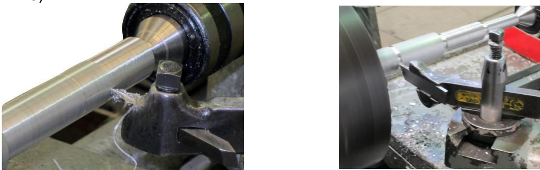
Figura 13. Colocación adecuada sin interferencia del porta herramientas
