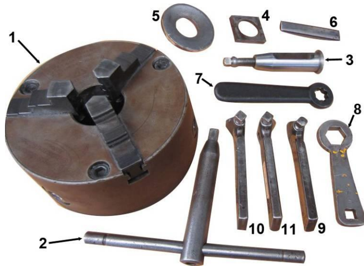
Figura 6. Partes de la caja de nueve piezas para torno y chuck con llave.
