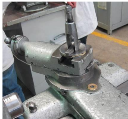
Figura 10. Colocación del árbol o poste del porta herramientas.
