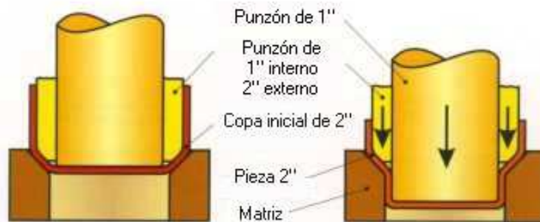
▲ Embutido con punzón telescópico
